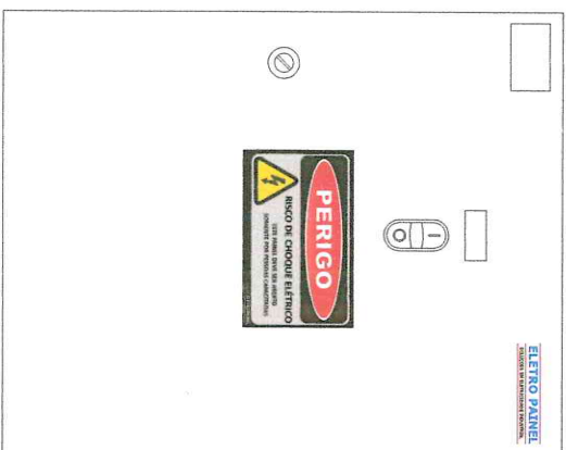
Quadro 500X400X200 (vista externa simplificada)
