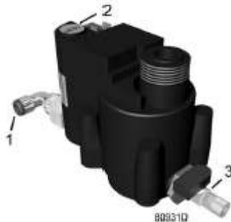
O secador está equipado com uma purga eletrônica de condensado (EWD). Os condensados do coletor de condensados acumulam-se num coletor. Quando os condensados atingem um determinado nível, são descarregados através da saída de purga (1).
