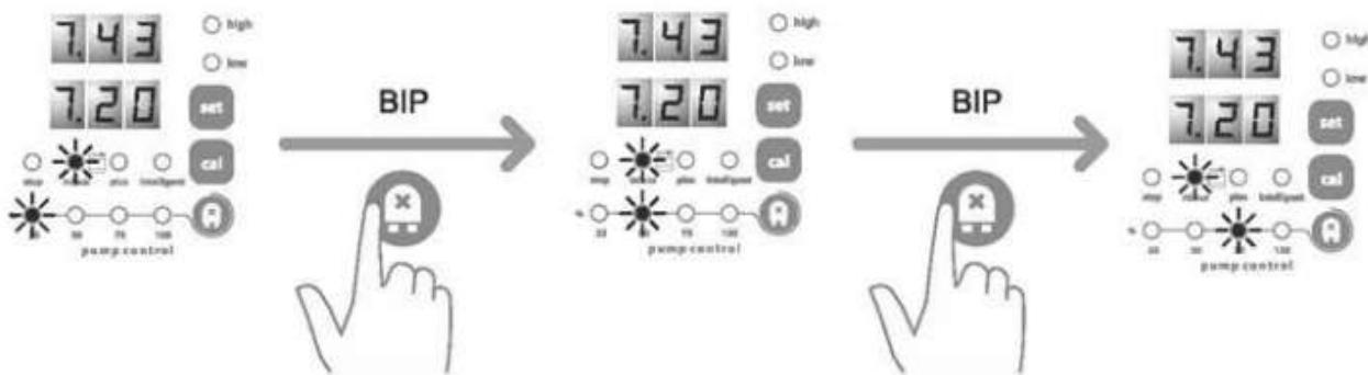
**Saída 1:** Configura-se a velocidade da bomba.
