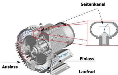
2-stufige Maschinen haben 2 Seitenkanäle mit jeweils einem Laufrad zur Erreichung eines besseren Enddrucks/Differenzdrucks hintereinandergeschaltet.
