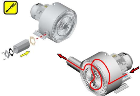
Bei zweistufigen Seitenkanalverdichtern nach 3. wird der druckseitige Schalldämpfer lose mitgeliefert und muss vor Inbetriebnahme installiert werden. Werkseitig montierte Metall-Verschlussdeckel nicht entfernen!
