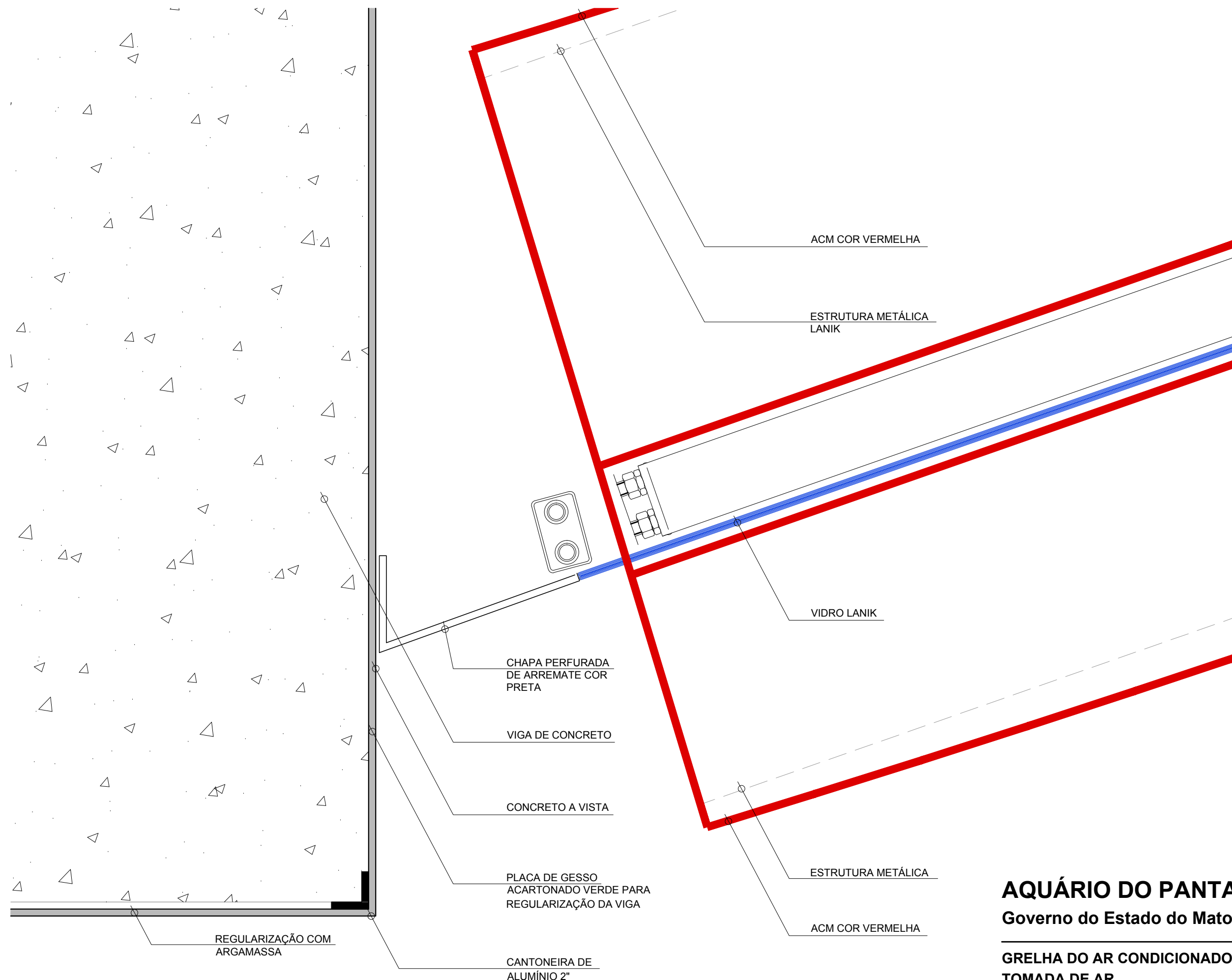
DETALHE DA GRELHA DO AR CONDICIONADO ESCALA 1:5
