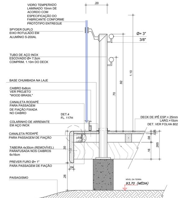
AMPLIAÇÃO MONTANTE TRECHO DE RAMPAS SOBRE VIGA
