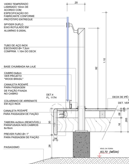
AMPLIAÇÃO MONTANTE COM ILUMINAÇÃO
