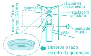
2. Meça a distância "X" entre a saída do sifão e o ponto de esgoto.
