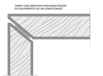
DETALHE 2 - ACABAMENTO DO TAMPO DE MANUTENÇÃO
