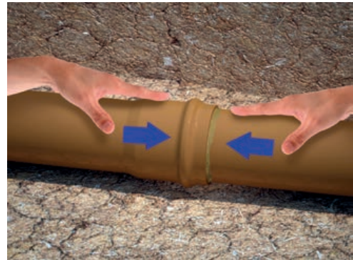
c) Encaixar a ponta chanfrada do tubo no fundo da bolsa, recuar 5 mm no caso de canalizações expostas e 2 mm para canalizações embutidas, tendo como referência a marca previamente feita na ponta do tubo. Esta folga se faz necessária para a dilatação da junta.
